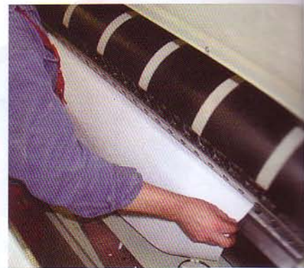
Beim Einstellen – Spielfreier Antrieb, parallele Messerschneiden und eine gute Feinjustierung sichern den optimalen Schnitt.
